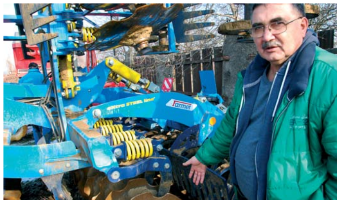
Každý tanier je uchytený a istený samostatne. Okrem toho, že tu je zaistené dokonalé kopírovanie terénu, v prípade potreby výmeny nejakého vymeniteľného dielu, napr. ložiska, nie je potrebné rozobrať celú sekciu, ale len konkrétne rameno.
