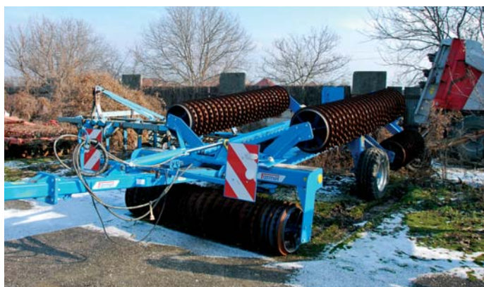
Cambridge valce so záberom 9 m majú zaujímavý a jednoduchý systém skladania. Podobne to však je aj pri zábere 6 m.
