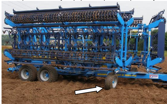
Obr.10-pomocná kola jsou připravena pro rozklápění stroje
