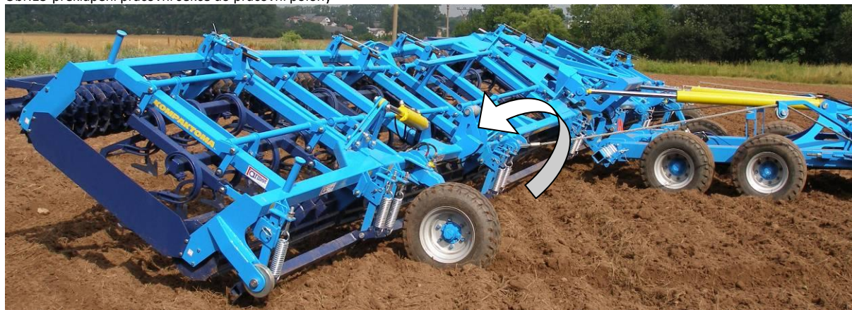
Obr.13-překlápění pracovní sekce do pracovní polohy
