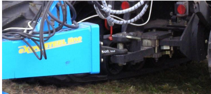
Obr.5-připojení stroje do spodního závěsu traktoru
