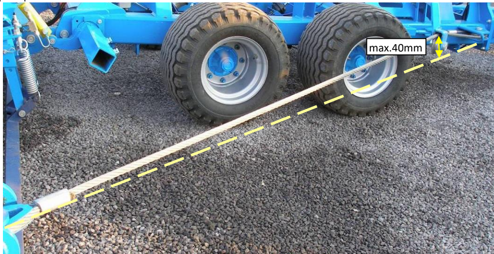
Obr.24-předepnutí tažného lana
