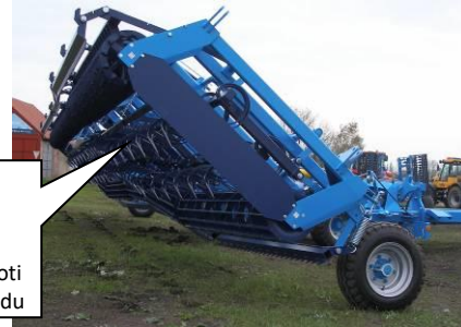
obr.31-poloha pracovní sekce pro výměnu radlic na poli
