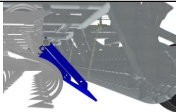
**AUSRICHTUNGSLEISTE HINTER DEN SCHAREN**
