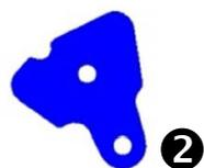
Der Anschlag der Schleppe ist drehbar gelöst, aber nicht symmetrisch. Aufgrund dessen können durch Drehung des Anschlags zwei Winkel der Schleppe gebildet werden.
