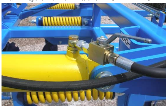
Рис.4 – шаровой вентиль в положении ОТКРЫТО
