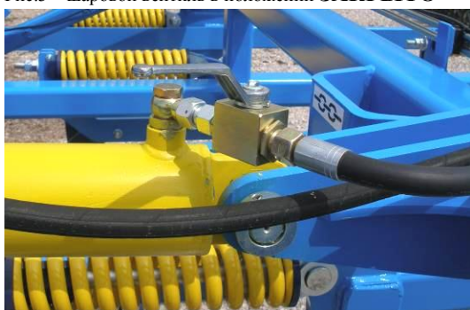
Рис.3 – шаровой вентиль в положении ЗАКРЫТО
