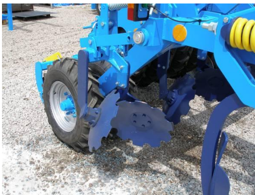
Рис.6 – боковые направляющие диски в транспортном положении
